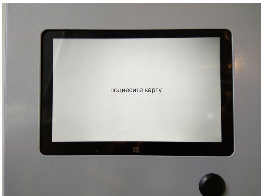
**Рисунок 3: Нейтральное состояние устройства**
